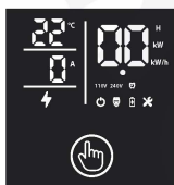
Stlačením tlačidla po dobu 3 sekúnd aktivujete nastavenie nabíjacieho prúdu. Potom tlačidlom nastavíte požadovanú hodnotu.
